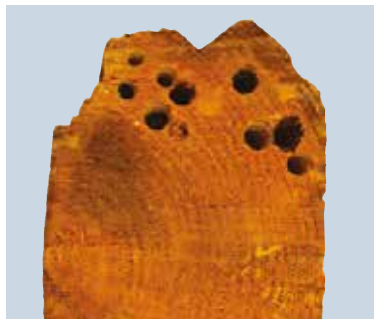
Figur 6. Kreosotimpregnert trevirke angrepet av pælemark i kjerneveden.
