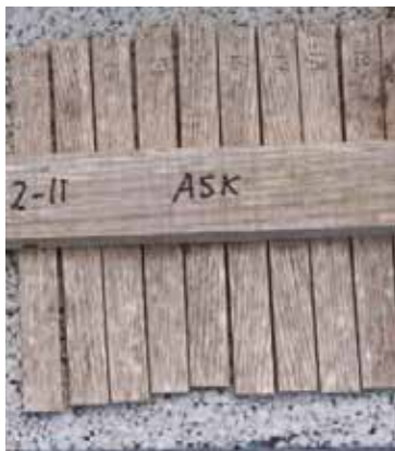
Figur 1. Småprøver på leca-blokk.
